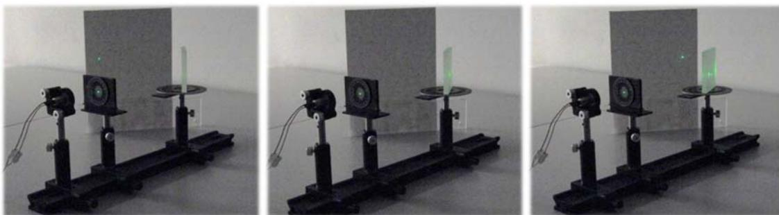
6. 重覆步驟4和5，調整入射角等於布魯斯特角。記下折射光與反射光的方向，測量入射角及折射角，驗證折射光是否與反射光垂直。
