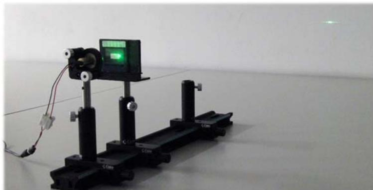
2. 調整單狹縫支架使雷射光在白屏(或牆)上產生三點或五點之繞射圖樣，請仔細畫下其圖形並用手機拍攝紀錄。
